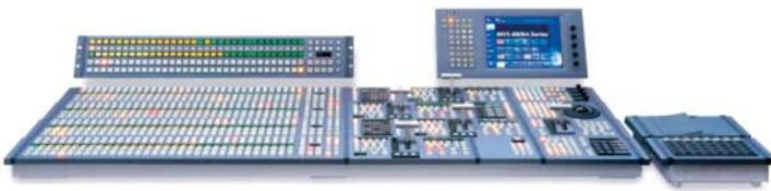
Video Switcher는 현재 거의 디지털화되어 있어 조작이나 운용방법도 소프트웨어에 의해 조정하도록 되어 있으며, 각 단의 Control Module(Input, M/E Bank, Keyer, Effect, Transition, DSK Module 등) 등을 조합하여 구매자의 선택에 따라 가변, 조합할 수 있는 스위처들이 출시되고 있는 실정이다.
