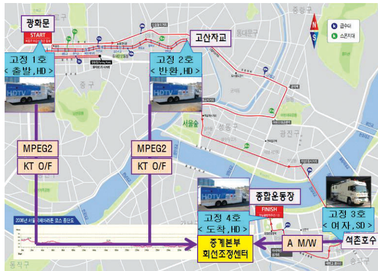
[그림 2] 고정 중계차 배치 및 회선구성도
