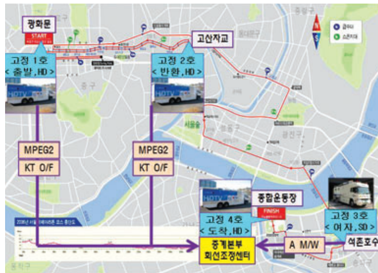
[그림 2] 고정 중계차 배치 및 회선구성도
