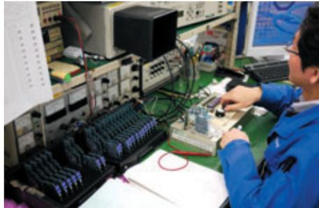
[카메라에 들어가는 모듈을 오실리스코프를 이용해 최종 테스트하는 모습]
