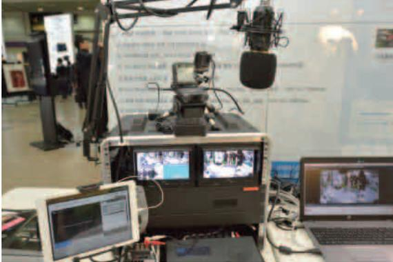
LiveWedge를 이용한 개인방송 시스템
