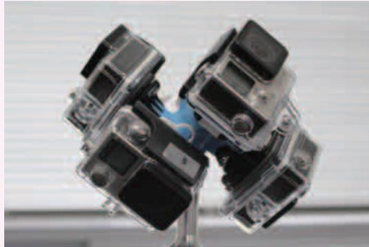
[그림 10] 방수하우징을 이용하는 RIG
