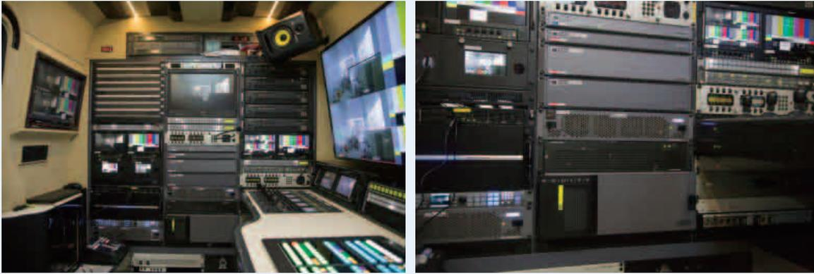
[그림 2] 4K&HD 하이브리드 중계차량의 내부에 설치된 4K 장비들
