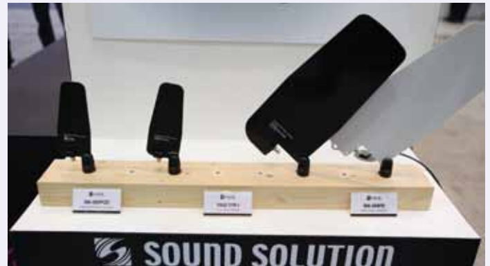
사운드솔루션이 개발한 900MHz 무선마이크용 무지향성 안테나
