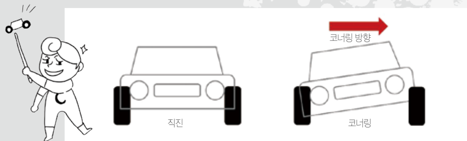
그림 5. 코너링 시 서스펜션의 캠버 보정에 의한 타이어 접지면 유지
