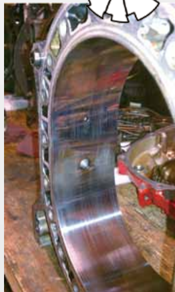
그림 6. 로터의 실(Seal)과 하우징의 마찰로 인한 손상 / 출처 : www.rx7club.com
