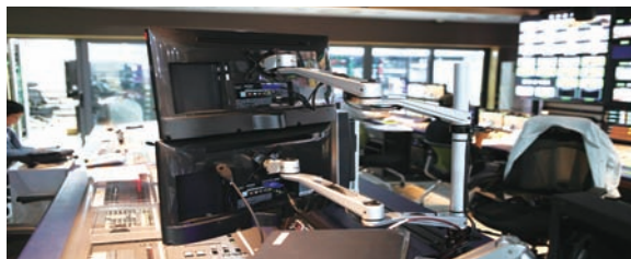
그림 21. 모니터 거치용 LCD암을 대폭 활용한 제작부조정실
