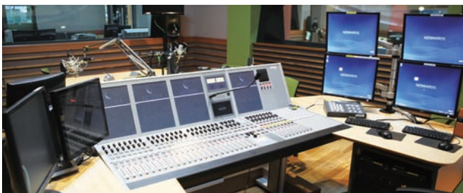
그림 21. 모니터 거치용 LCD암을 대폭 활용한 제작부조정실
