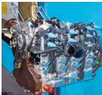
그림 5. 1990년 르망 24시간 레이스 우승을 목표로 개발된 700마력 로터리 엔진 출처 : www.gopixpic.com
