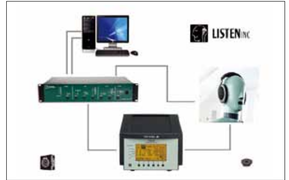
그림 4. 헤드폰 측정 장비 구성도
