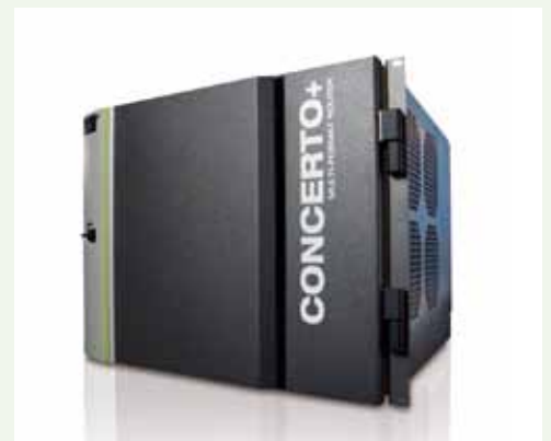
[그림 3] Baseband에서 N:N 통신을 위해 사용하는 Patch-panel/Router
