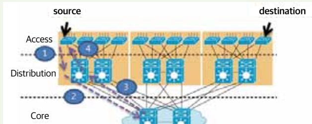
[그림 10] Baseband에는 발생하지 않는 Loop 문제가 발생할 수 있어서, 방지가 필요하다
