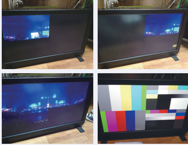
[그림 3] 케이블 로스 및 잘못된 연결에 따른 영상 확인
