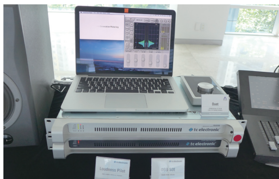
세미나장 밖에 전시된 TC Electronic의 라우드니스 관련 제품들 (DB6 : 방송용 오디오 프로세서, Loudness pilot : 듀얼 스테레오 라우드니스 프로세서, UpCon : 고해상도 오디오 업컨버터, System6000+TC Icon : 디지털 리버브 & 시그널 프로세서, D-22 : 디지털 방송용 딜레이, Reverb 4000 : 싱글 엔진 스테레오 리버브 프로세서)
