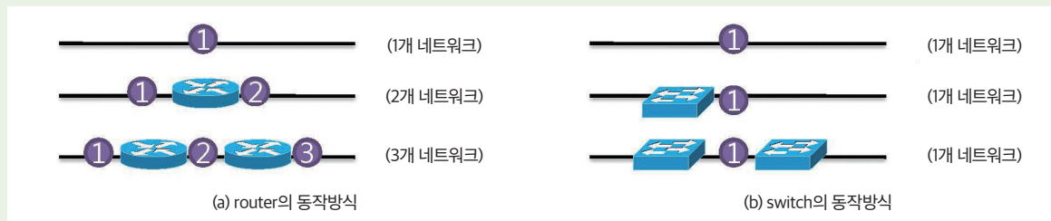
[그림 1] router는 네트워크를 분할하지만, switch는 네트워크를 분할할 수 없다
