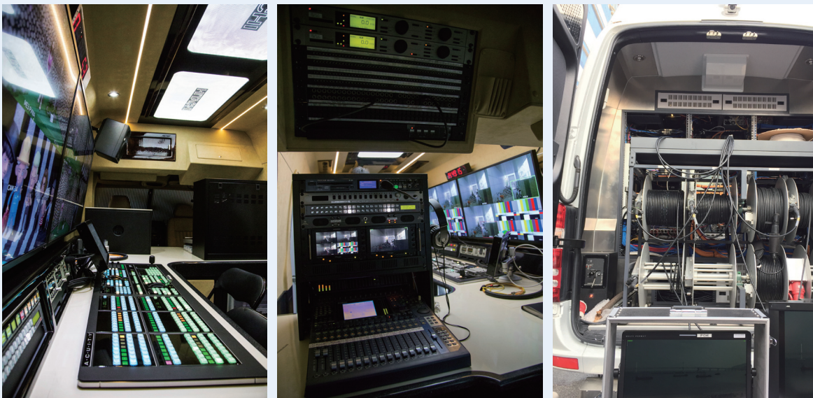
[그림 4] 실용적이면서 고급스러운 차량 내부 인테리어와 앞자리 조수석에 마련된 오디오 관련 장비, 후방에 설치된 자동 드럼
