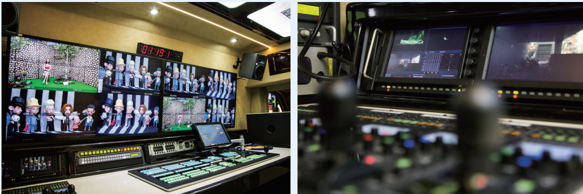
[그림 3] 4K를 완벽히 지원하는 ROSS사의 AUCITY 스위처와 Tektronix 계측기
