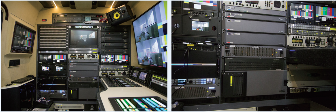
[그림 2] 4K&amp;HD 하이브리드 중계차량의 내부에 설치된 4K 장비들
