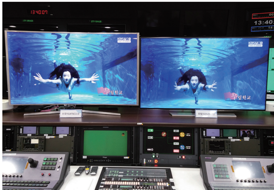
그림 9. ATSC 3.0 vs DVB-T2 비교실험 (좌 : ATSC 3.0 온에어 송수신, 우 : DVB-T2 로컬 송수신)
