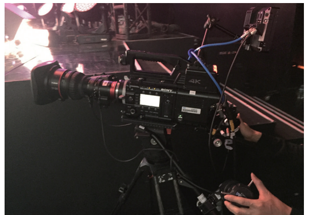
그림 9. CAM 5번 : Sony 4K 카메라 (PMW-F55) 17-120mm (Canon) PL
