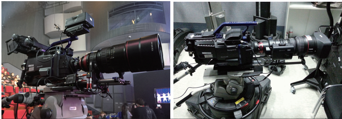
그림 4. CAM 1번 : Ikegami 카메라(HDK-97ARRI) 28-340mm(Angenieux) PL, 50-1000mm(Canon) PL
