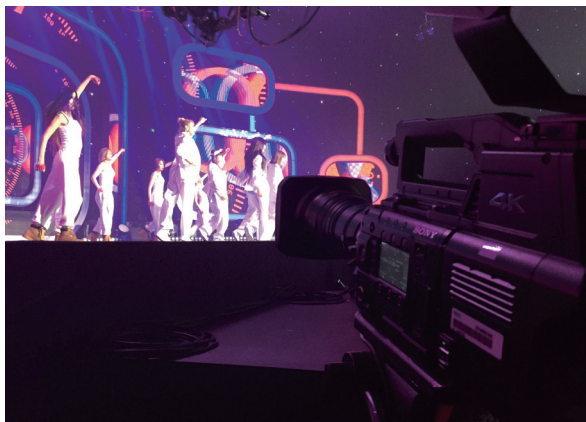
그림 8. CAM 4번 : Sony 4K 카메라 (PMW-F55) 19-90mm (Fujinon) PL
