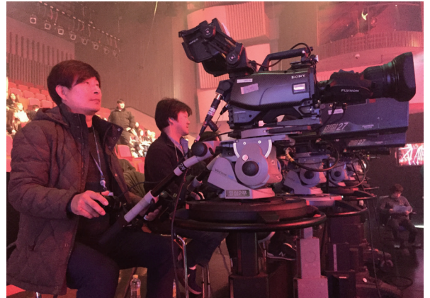
그림 7. CAM 3번 : Sony 4K 카메라(HDC-4300) 8-176mm (Fujinon) B4
