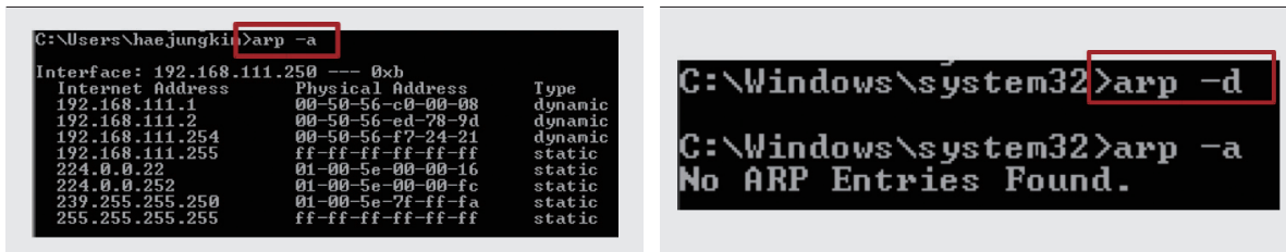
그림 9. arp -a 명령은 ARP cache table를 보여줍니다
