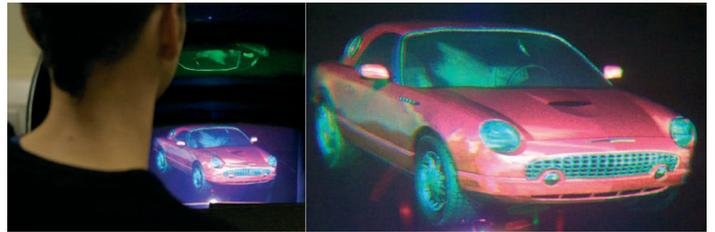
그림 7. QinetiQ 사의 active tiling 방식의 홀로그래픽 디스플레이 [3]
