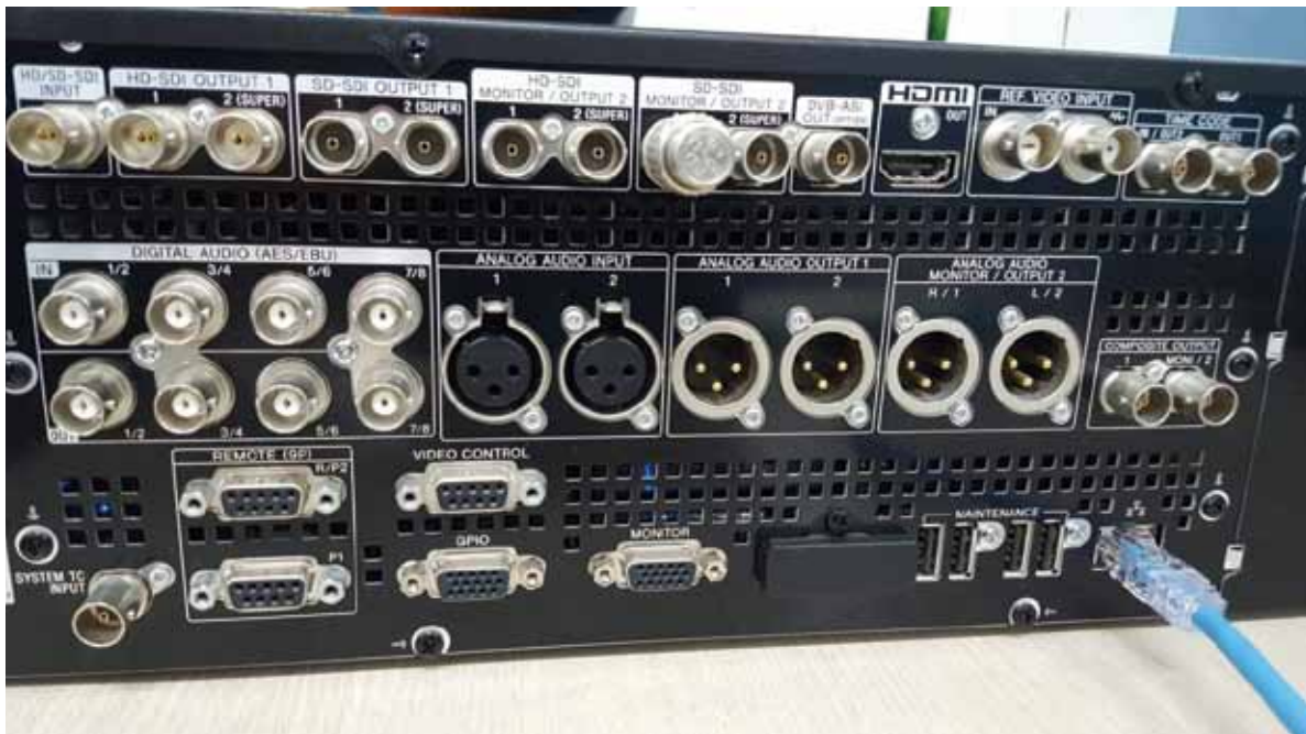
그림 1. 서버의 Rear Panel I/O Board와 네트워크 Cable 단자
