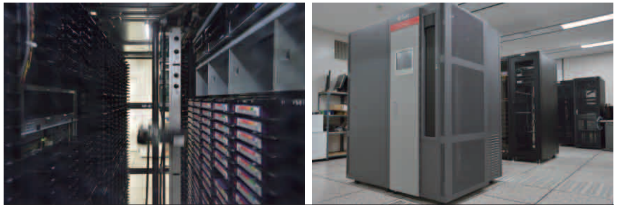
그림 28. 2층 전산실의 Oracle StorageTek SL3000 Modular Library System
