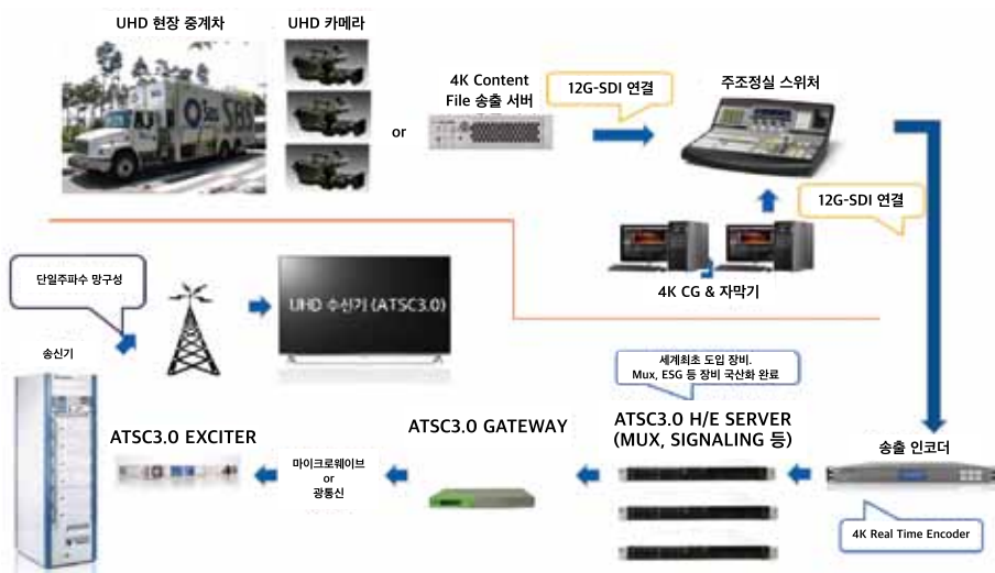
그림 1. 세계 최초로 본방송 준비를 마친 지상파 UHD 방송시스템의 주요 구성도
