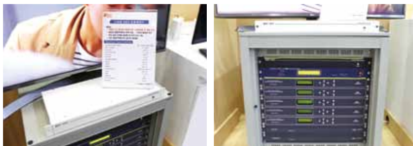
그림 8 랙 상단 하얀색 제품, '700MHz 대역형' 신호처리기(UHD Korea)(좌), 랙 하단 검정색 제품, 'IF형' 신호처리기(디지털텔레리아)(우)
