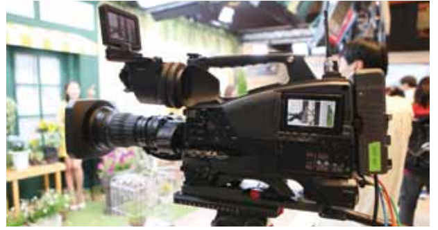
2/3인치 4K CMOS 이미지 센서를 탑재한 4K XDCAM 메모리 캠코더 PXW-Z450
