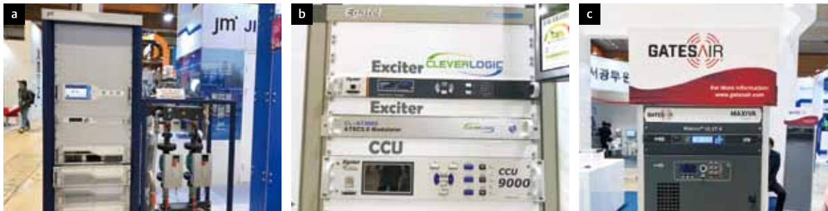
그림 5 (a)우리나라 진명통신/ProTelevision (b)스페인 Egate/클레버로지 (c)미국 GatesAir(브이아이텔레콤), 전시된 송신기 모두 5kW급 고효율 송신기임.
