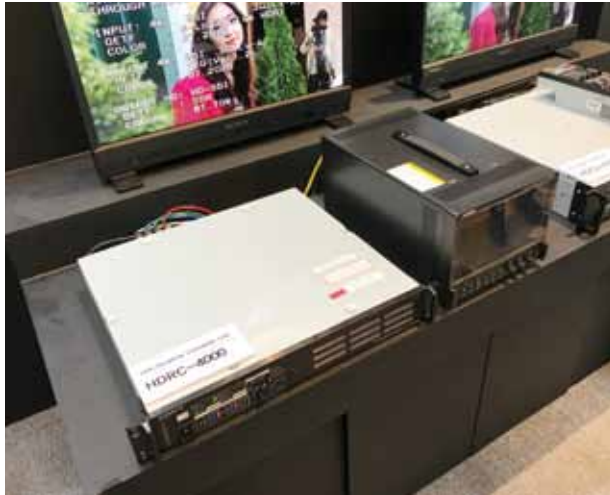
SONY社의 HDRC-4000과 다양한 HDR 모니터링 장비들 HDRC-4000의 경우 촬영자가 제작 현장에서 모니터링하는 HDR 룩을 HLG로 컨버팅할 때도 동일한 룩과 휘도를 관리할 수 있게 하는 Air Matching이라는 기능이 탑재되어 있다고 한다.
