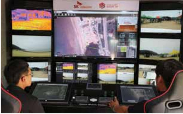
DMS의 내부, 드론 컨트롤 및 영상 분석을 위한 관제시스템이다
