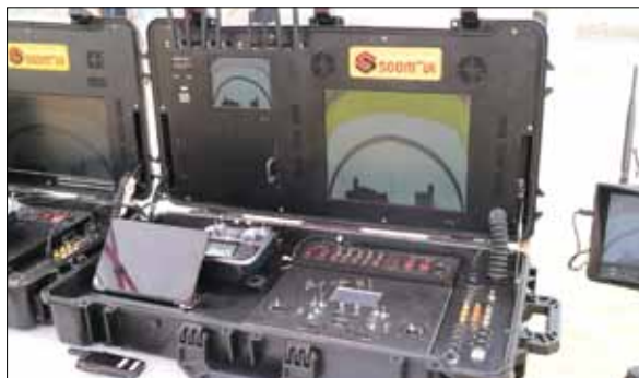
해수욕장에 마련되었던 드론 실시간 관제 시스템 GCS, 드론으로부터 전송되는 영상의 수신 및 분석이 이루어지며, 자동 비행 및 모니터 조종을 지원한다.
