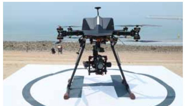
정찰드론(V-100), 최대 풍속 13m/s에서도 안정적인 비행이 가능하며, 항공영상 처리를 통한 3D 정보를 생성하며, 안내방송도 송출한다
