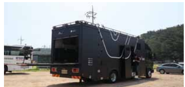
이동형 관제센터(Drone Mobile Station), LTE를 통해 차량 내에서 드론을 제어, 실시간 영상 송출 및 분석을 통해 빠른 대응 능력을 보유했다
