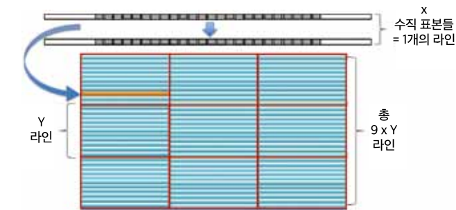
그림 11. C300 Mark II 영상 센서의 AF 감지를 구성하는 더욱 커진 샘플링 격자
