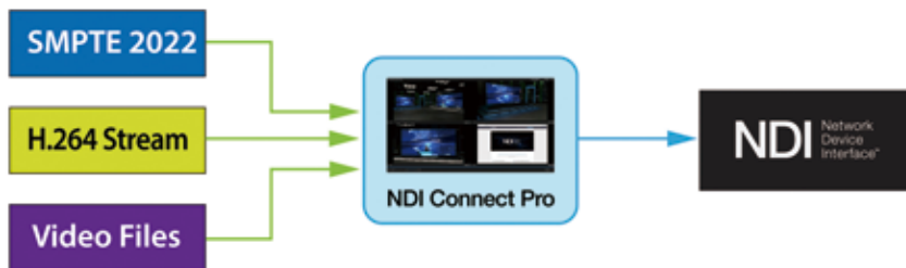
기존의 IP 스트림이나 비디오 파일을 NDI로 변환하는 Connect Pro
