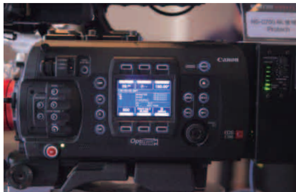
업계 표준의 GUI를 적용한 촬영 조작 버튼과 LCD
