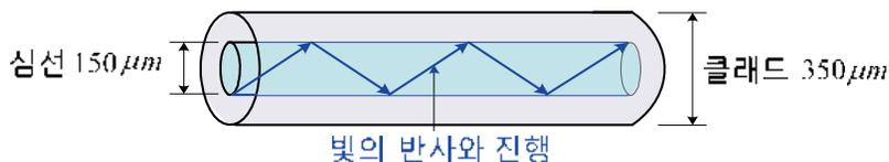
광섬유 케이블은 다음과 같이 발광다이오드(LED : Light Emitting Diode)를 이용한 전기-광 변환장치, Photo Transistor를 이용한 광-전기 변환장치 및 광섬유 케이블로 구성된다.
