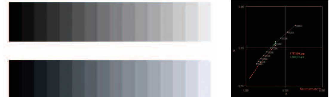
그림 7. 계조선형성이 좋은 경우와 그렇지 못한 경우 (전형적인 저가형 LCD)의 비교 / 출처 : 모니터포유
