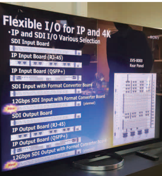
4K 스위처 Rear Panel. SDI와 IP I/O 선택의 유연함
