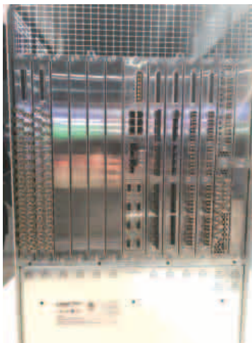
K-FRAME X 15RU / MAX 192×96 IP I/O 보드 SDI I/O 보드 Pass HDR Signal IP Standards - SMPTE 2100-20, 50 - 2022-7 - TICO 호환성 유지
