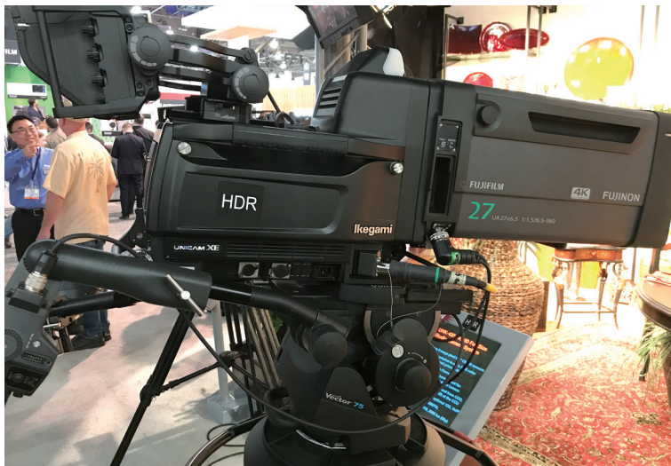
UHK-435, 2/3인치, 3-CMOS 센서 기반 4K/HD Full 스튜디오 카메라. 3개의 2/3인치 4K(3840×2160) CMOS 센서를 통한 4K 해상도를 제공하며 센서당 800만 픽셀, 전체 2,400만 픽셀에 이른다.
