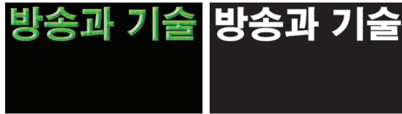
그림 3. 문자 그래픽의 Fill(좌) 영상과 Key(우) 영상
