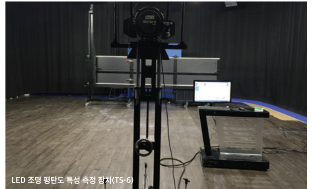
LED 조명 평탄도 특성 측정 장치(TS-6)
