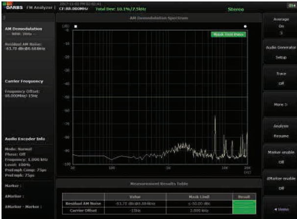
잔류진폭변조잡음 및 주파수허용편차 측정
