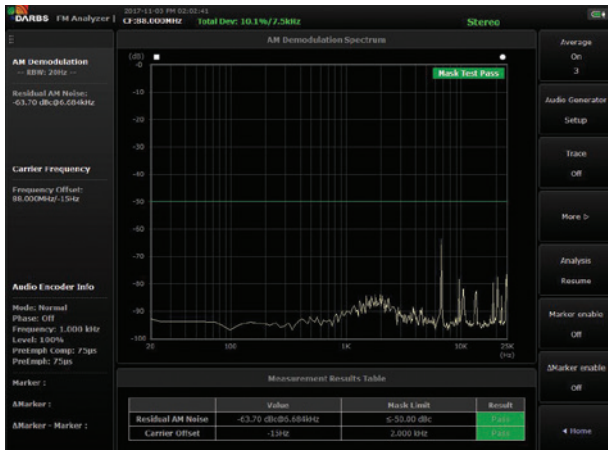
잔류진폭변조잡음 및 주파수허용편차 측정
