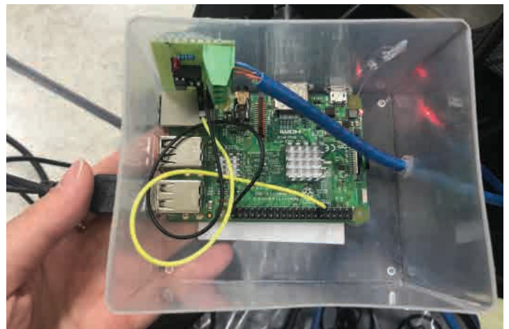
Raspberry Pi 3 모듈 및 Photo(opto) Coupler 회로 모듈
