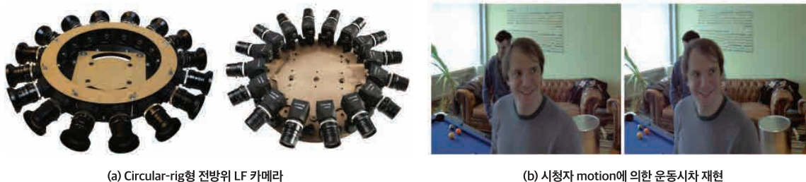
(a) Circular-rig형 전방위 LF 카메라
