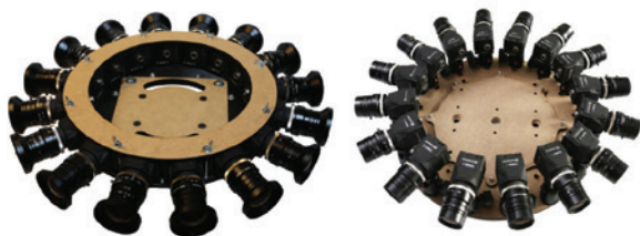
(a) Circular-rig형 전방위 LF 카메라
