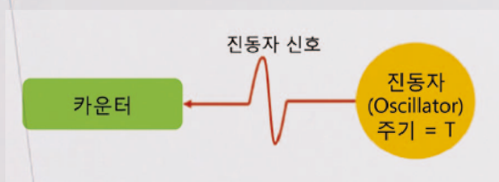
그림 3. 진동자와 카운터를 이용한 시간 측정
