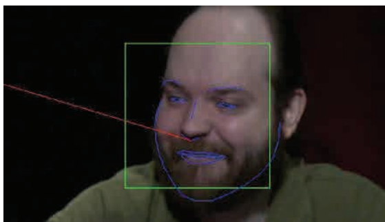
그림 1. 얼굴 탐지 경계 상자(녹색), 얼굴 랜드마크(파란색), 머리 자세 투영(head pose projection, 빨간색)
