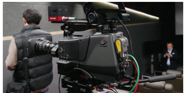
GV 카메라에 장착된 Sensor(상단)/Processor(하단) Unit
