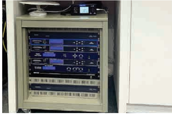
그림 8. KBS 전시장 / ATSC 3.0 소출력 중계기와 재변조형 공시청 신호처리기 그림 9. UHD-KOREA / ATSC 3.0 700MHz 대역형 신호처리기, 채널지정형 신호처리기, 재변조형 공시청 신호처리기, 그리고 신호분석기
