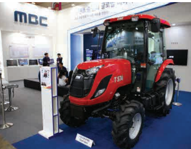
MBC RTK 서비스 수신기인 MRD-1000T를 통한 (썬동양물산의 자율주행 트랙터
