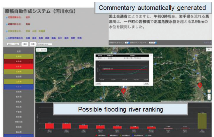
자동 뉴스 원고 작성시스템 : 하천의 수위(하단)에 따라 뉴스 원고가 자동으로 생성되는 구조(우측 상단)
