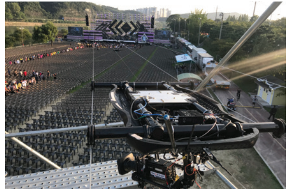
그림 8. 가요무대 Aerial Production System 설치 모습
