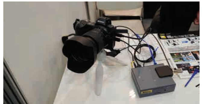
Nikon社 DSLR 카메라에 연결하여 모바일로 원격조정 및 영상 전송하여 스위칭하게 하는 솔루션
