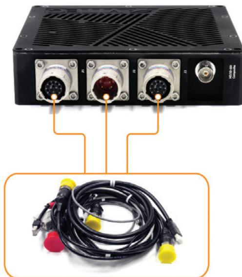
MGW Tough 제품군은 방수, 방진, 방습을 위해 특수한 케이블을 사용합니다
