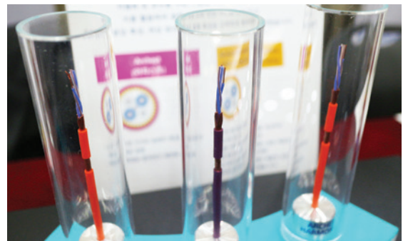
케이블 단면 전시, Star Quad 구조 적용과 불소수지 사용으로 신호 손실을 최소화한다
