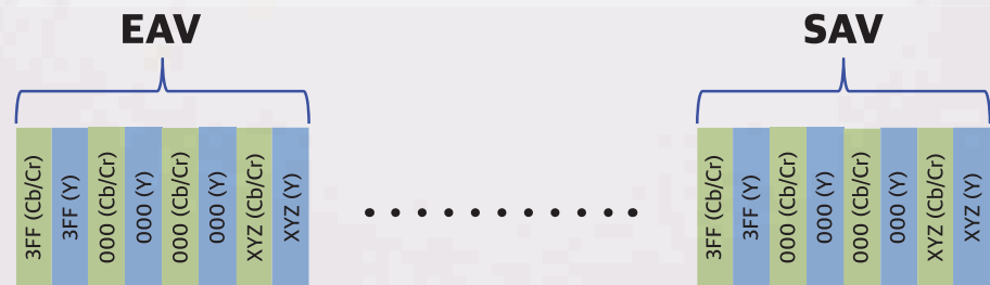
그림 5. 시리얼 데이터로 전달되는 EAV와 SAV
