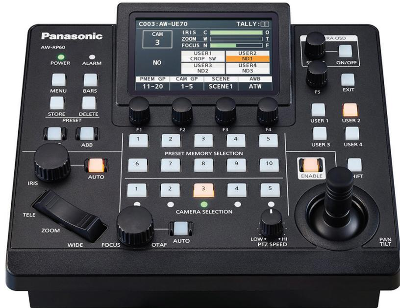
파나소닉의 원격 카메라 컨트롤러 AW-RP60GJ는 3.5인치 LCD 스크린을 장착하여 선명한 가시성을 위한 GUI 메뉴 스크린을 지원하며, 직관적 컨트롤을 위한 조이스틱 장착으로 부드러운 팬과 틸트 동작을 지원한다. 4개의 사용자 버튼을 갖추고 있어, 카메라 컨트롤의 편의를 제공한다. 싱글 케이블 연결로 PoE를 지원하여 사용의 간편함도 더했다.
